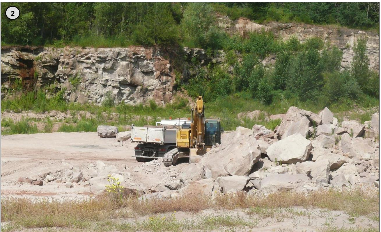
2. Vue sur la partie centrale de la fosse en activité. L'extraction du gisement est réalisée par tir de mines puis reprise des blocs à la pelle mécanique. L'évacuation des matériaux est assurée par un seul camion. Juin 2019.
